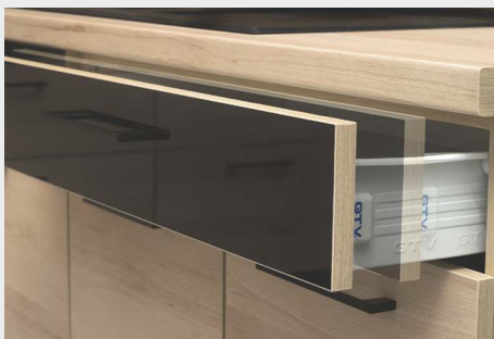
Szuflady z cichym domykaniem. Fronty akrylowe w wysokim połysku oklejone obrzeżem w kolorze frontów laminowanych. Obrzeża klejone wodoodpornym klejem PUR.
